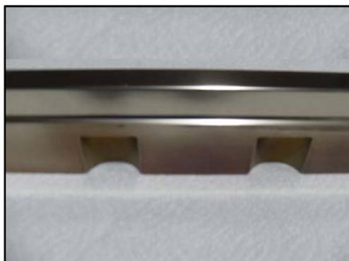
**Figura 2.** Ferramenta para deformação a frio após revestimento com HTS-V10®.
