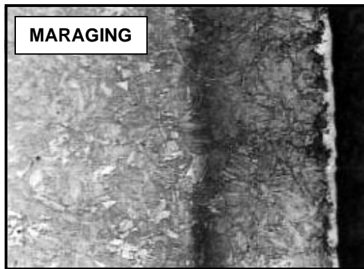
Figura 1 – Microestruturas após a Nitretação por Plasma. Nital 4%. 180x.
