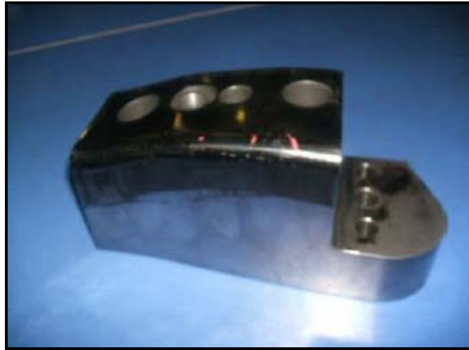
Figura 5. Segmento de ferramenta de conformação a frio recoberta com HTS-V10®.
