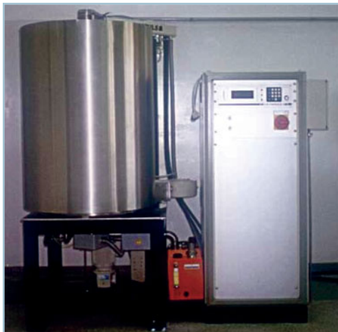
Fig. 1 – Reator de nitretação por plasma pulsado
